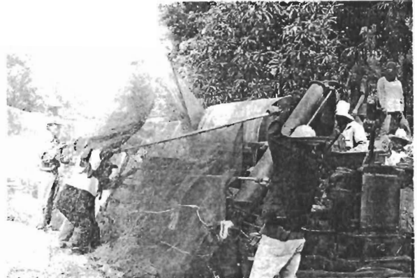
รูปที่ 6 การสุ่มตัวอย่างเพื่อหาความสูญเสียจากการใช้เครื่อง นวดข้าว
