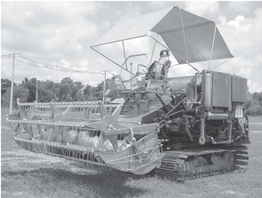
รูปที่ 2. เครื่องเกี่ยวนวดข้าวแบบไหลตามแกนที่ใช้ในการศึกษา
