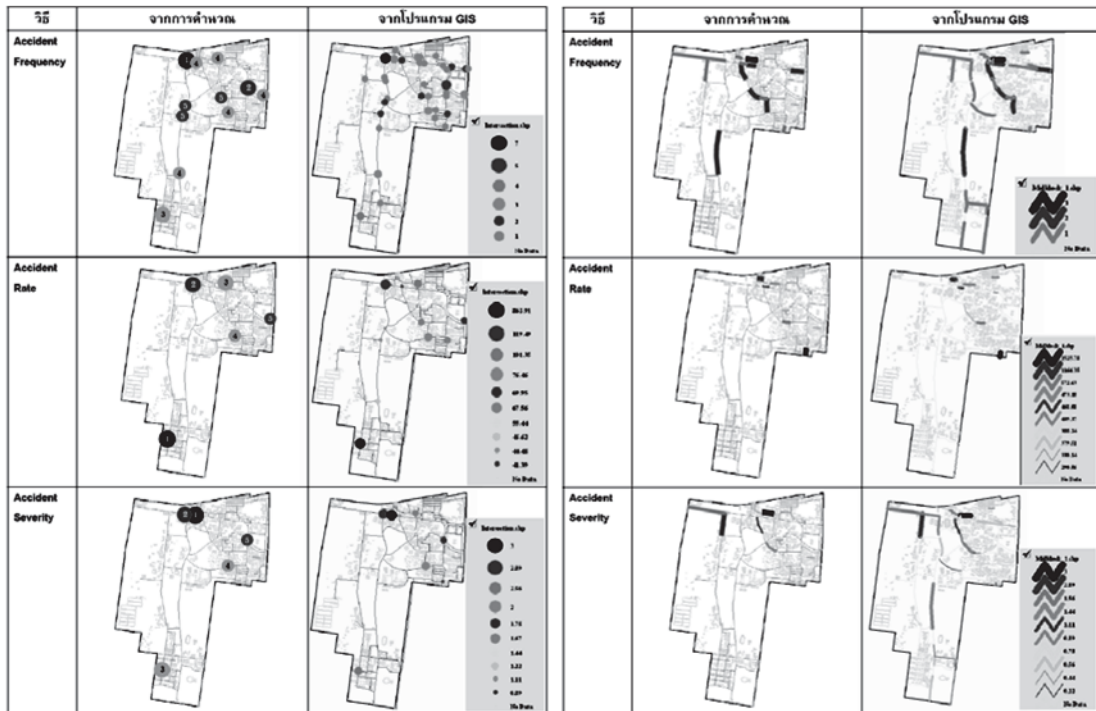
รูปที่ 7. การเปรียบเทียบตำแหน่งจุดอันตรายจากการคำนวณและจากโปรแกรมที่พัฒนาขึ้น
