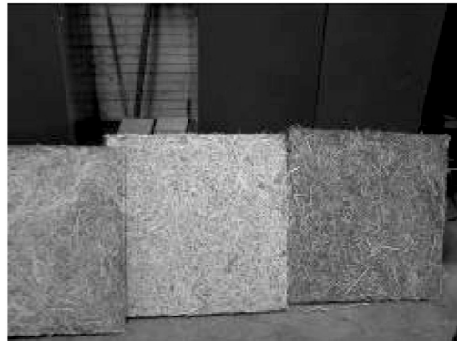
รูปที่ 1. แผ่นฉนวนกันความร้อนหลังจากตากแดด
